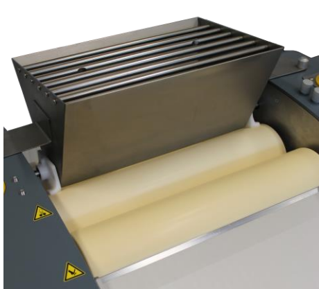
可配各種高品質滾筒：Al 2 O 3 、SiC、STEEL
