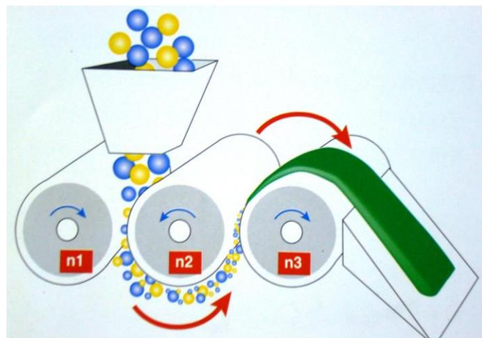
漿狀物料由進料斗添加至進料滾筒與中間滾筒之間的縫隙當中，實現分散這一過程，物料附著於中間滾筒的底部，並隨滾筒滾動方向進入第二道縫隙，實現分散及研磨的過程，達到最終需要的細度等級。而後，刮刀系統將製成的物料從出料滾筒上移除。
